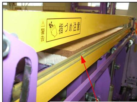
下側チャックの山の部分と床の上面を合わせる
