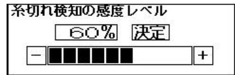
「-」「+」スイッチを押して感度を変更したあと、「決定」スイッチを押して確定してください。
