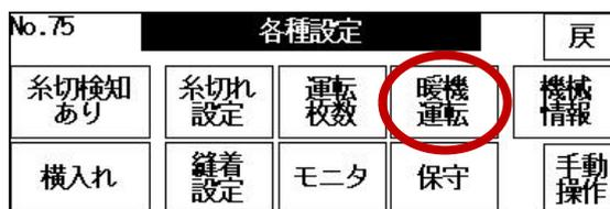
3. 暖機運転画面で、切替スイッチを『自動』に切り替え、操作盤にある**運転スイッチ**を押すとミシン単独で運転を開始します。
