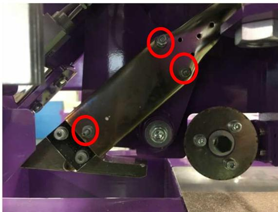
1) 八角刃回転ユニットを取り外し、刃物ユニット走行部に仮置して下さい。
