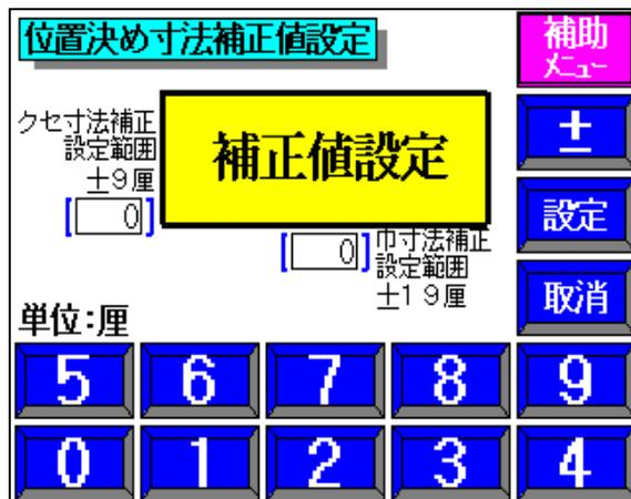
【床厚寸法補正值設定】
